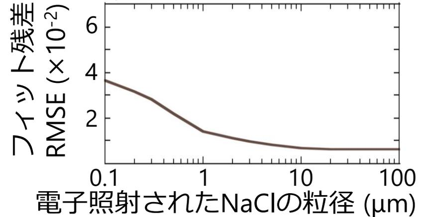
**二つのデータで共通して粒径 < a few μmでは残差が大**
